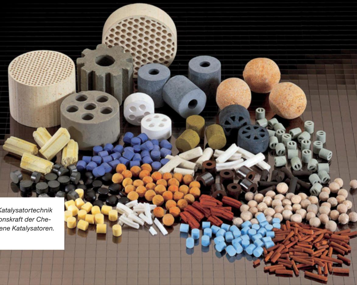
Gerade in der Filter- und Katalysatorteknik kommt es auf die Innovationskraft der Chemie an. Im Bild: verschiedene Katalysatoren.
